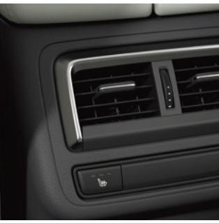
Las salidas de la ventilación con persianas en la parte posterior de la gran consola central frontal proporcionan un flujo de aire ajustable independientemente a los pasajeros en la parte posterior del vehículo. Los asientos izquierdo y derecho posteriores están climatizados con un control de temperatura de tres fases.
