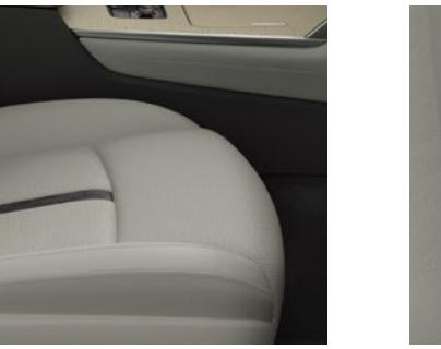
El sistema de ventilación de los asientos frontales retira el aire caliente y húmedo de las áreas donde el cuerpo está en contacto con la superficie del asiento para una mayor comodidad. Las perforaciones están distribuidas de manera amplia y uniforme en el respaldo y el cojín del asiento para una máxima eficiencia, y el sistema ofrece un control de tres fases.
